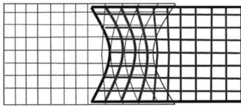
Abb. 3: Überlappung Auffangnetze  $\geq 2.0\text{ m}$
