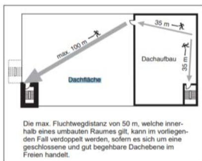
Abbildung 408-11: Maximale Fluchtwegdistanzen auf Dachflächen
